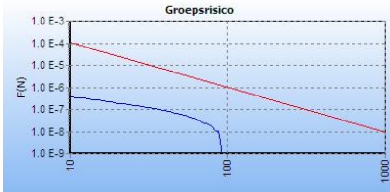
Figuur 15. GR-curve 5: leiding W-532-01 stationing 8400 - 9400
