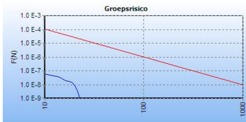
Figuur 16. GR-curve 6: leiding W-532-01 stationing 9700 - 10700
