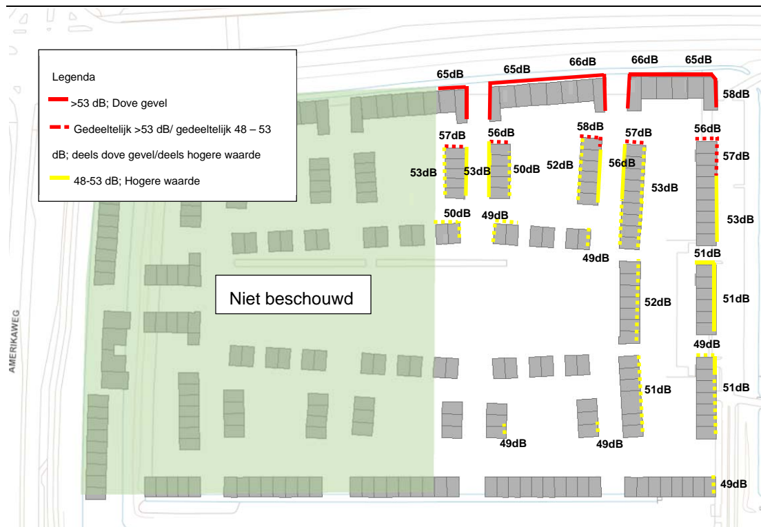
Figuur 5.2 Weergave gevels met geluidbelasting hoger dan de voorkeursgrenswaarde (geluidbelasting Inc. Aftrek 110g Wgh)
