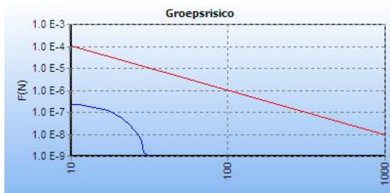
Figuur 17. GR-curve 7: leiding W-532-06 stationing 0 - 560
