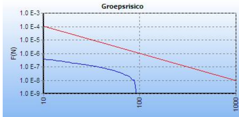
Figuur 15. GR-curve 5: leiding W-532-01 stationing 8400 - 9400
