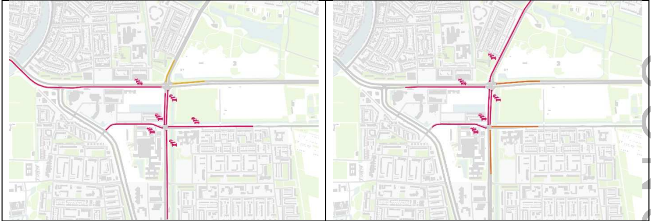
figuur 5.1: Wachtrijvorming op voor de kruispunten in de autonome feitelijke situatie (links ochtendspits en rechts avondspits)
