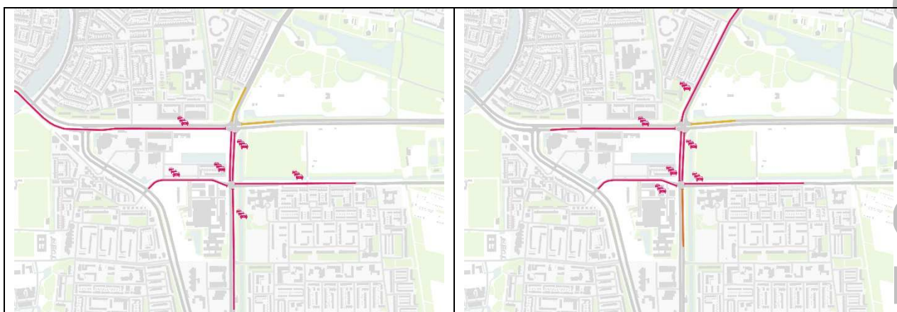
figuur 5.4: Wachrijvorming op voor de kruispunten in de autonome juridische situatie (links ochtendspits en rechts avondspits)
