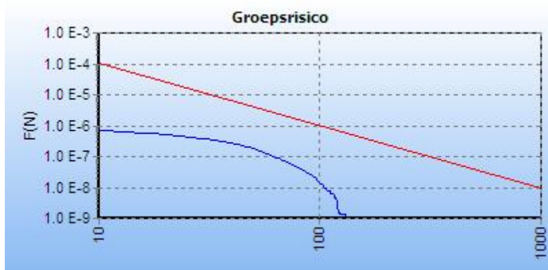
Figuur 13. GR-curve 3: leiding W-532-01 stationing 5800 - 6800
