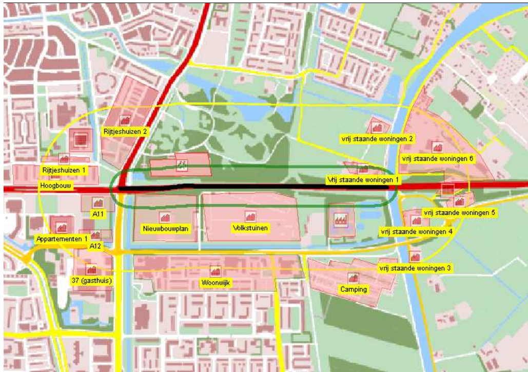
Figuur 4.1 Plaatsgebonden risico 10^{-8} (groene lijn) per jaar als gevolg van het vervoer van gevaarlijke stoffen over de N205 Schipholweg
