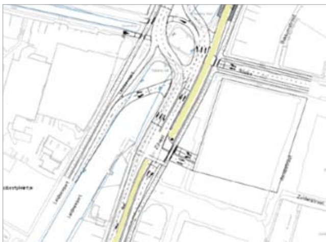
Figuur 23: Schets inpassing vrije ov baan (geel) wilhelminastraat/raaks.
