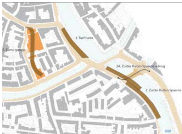
Figuur 18: Mogelijke tunnelmonden aan de stadszijde bij tracé A.
