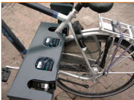
Figuur 1: LocknGo stallingsklem met paslezer voor twee fietsen
