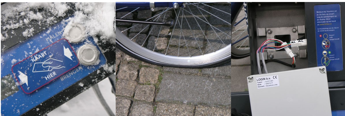
Vastgevroren knoppen, lekke achterband, defecte sleuteldetectie
