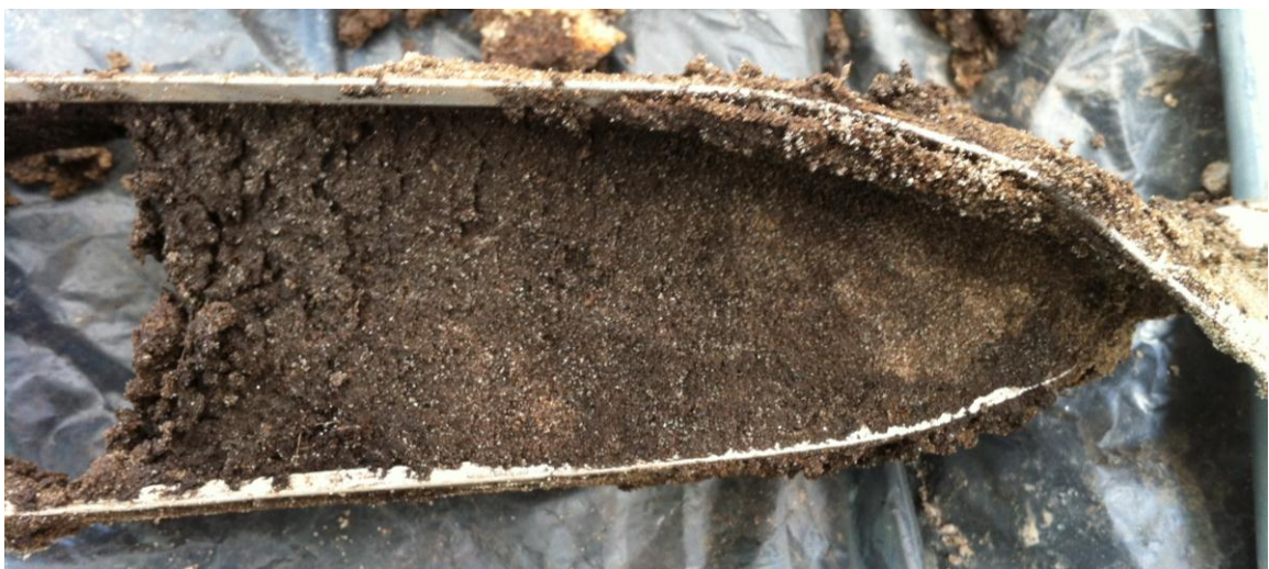
Boring 3: veenlaag met uitgeloopte zandkorrels
