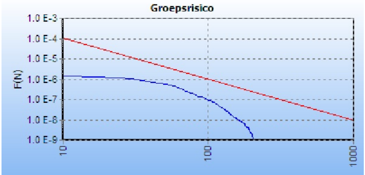
Figuur 2. GR-curve leiding W-532-01 stationing 7100 - 8100
