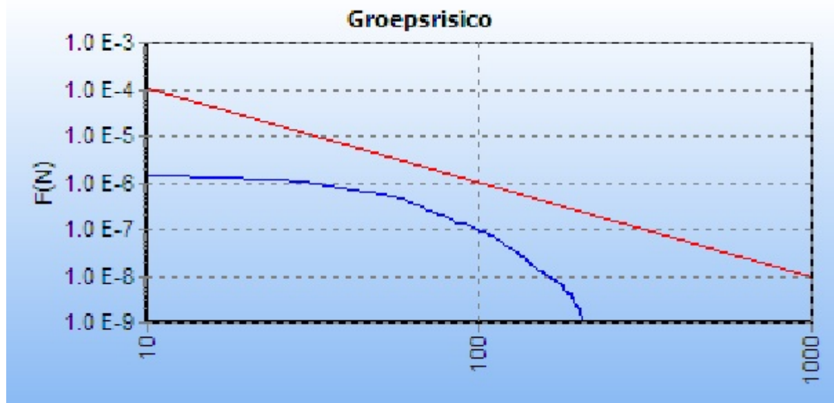
Figuur 2. GR-curve leiding W-532-01 stationing 7100 - 8100
