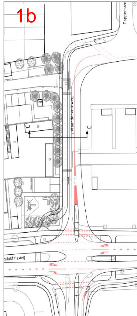
Figuur 5 Fietspad west met verschoven rijweg
