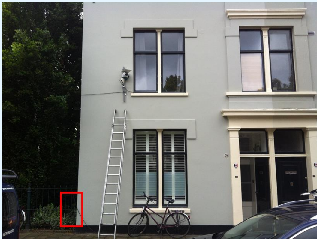
figuur 11: voorgevel onderzoekslocatie Parklaan. Met rood is de locatie van de trillingsopnemers weergegeven.
