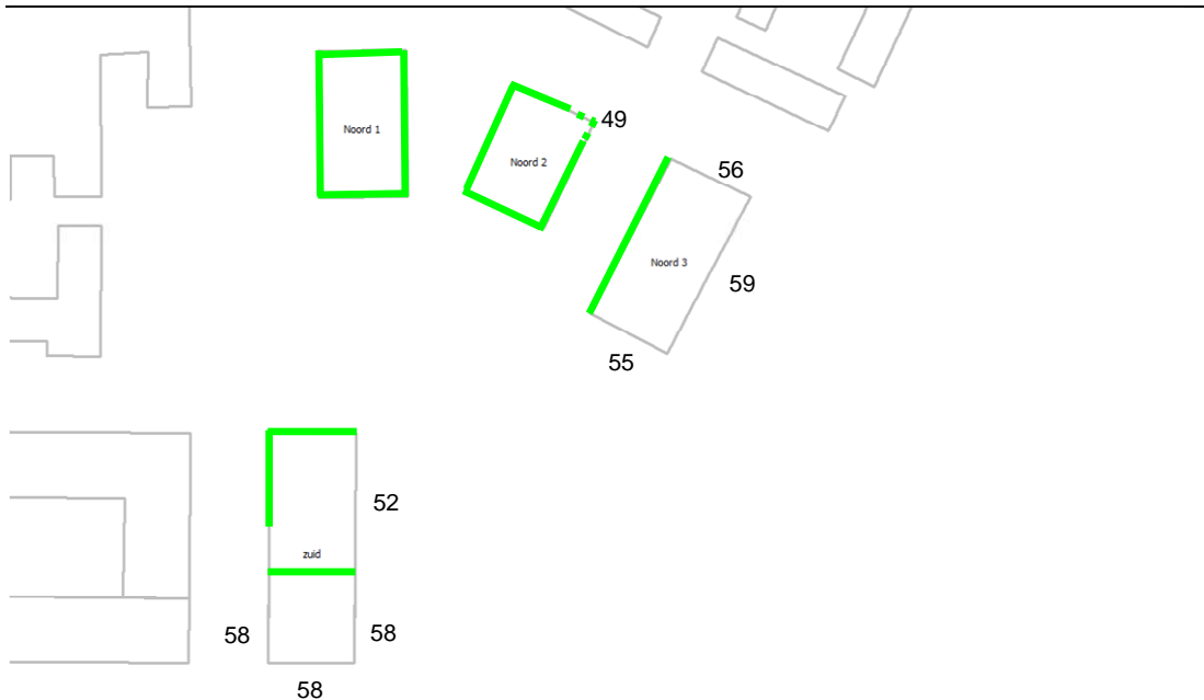
Figuur 6.2 Maximaal berekende geluidbelasting en geluidluwe gevels Concept B, groen = geluidluwe gevel, groen gestippeld = geluidluw op begane grond en 1e verdieping
