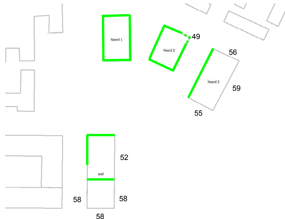
Afbeelding boven: maximaal berekende geluidsbelasting en geluidluwe gevels. groen = geluidluwe gevel groen gestippeld = geluidluw op begane grond en 1e verdieping
