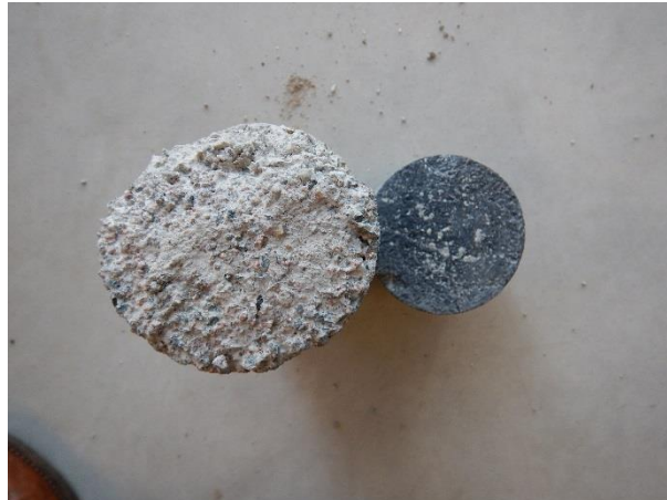
Figuur 1.2: Hechtvlak steen / splitbeton locatie 2
