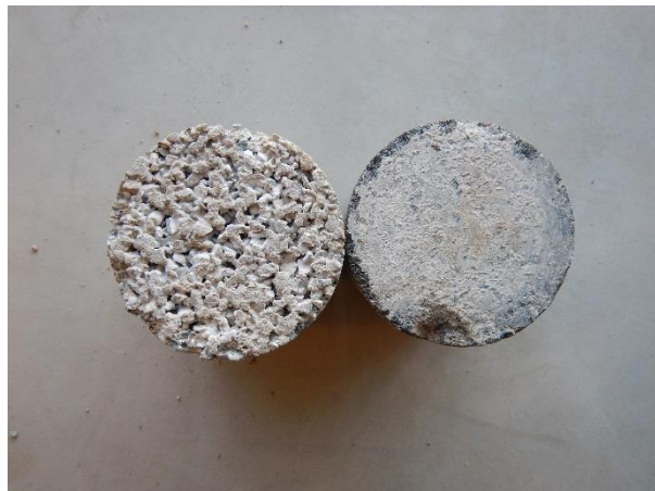
Figuur 1.4: Hechtvlak steen / splitbeton locatie 4
