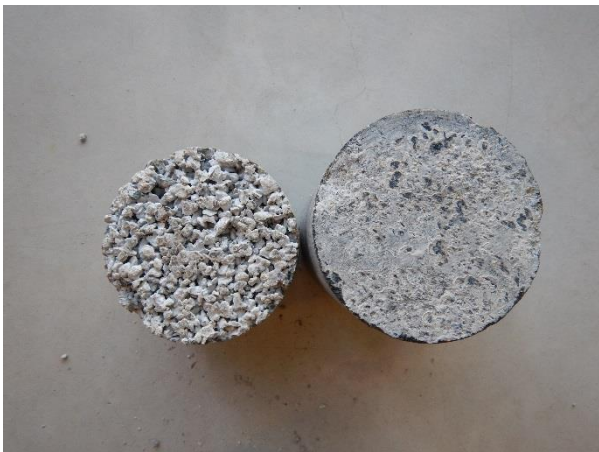
Figuur 1.3: Hechtvlak steen / splitbeton locatie 3
