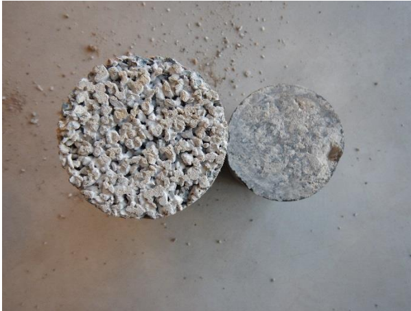
Figuur 1.7: Hechtvlak steen / splitbeton locatie 7
