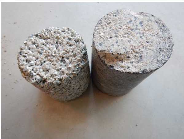
Figuur 1.5: Hechtvlak steen / splitbeton locatie 5
