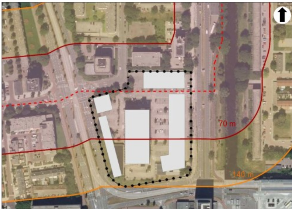
Afbeelding 2.1: Ligging aardgastransportleiding en effectafstanden ten opzichte van het bouwplan (rood = eerste ring, oranje = tweede ring).
