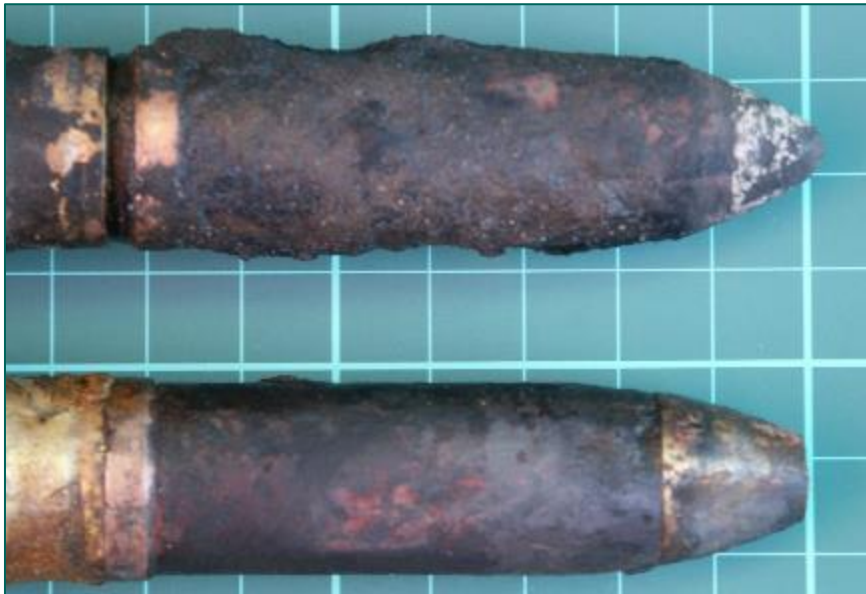
Figuur 130: 20 mm brisantgranaat en 20 mm pantsergranaat (Bron: Database REASeuro).
