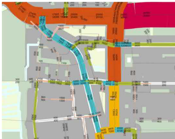
figuur 2.1: Verkeersintensiteiten 2030 [mvt/etmaal] SOR-variant zonder Kennemertunnel (NHZ-versie 2.31)
