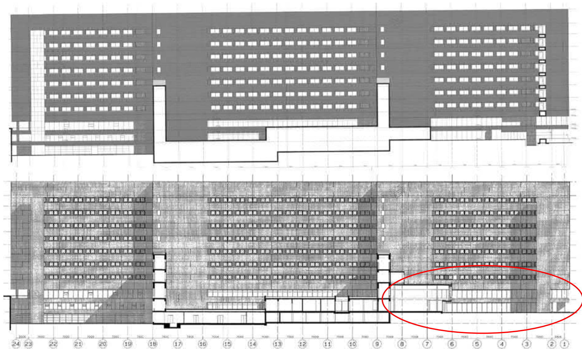
Noordgevel gebouw 1, 2 en 3 bestaande situatie (boven) en nieuwe situatie (beneden). De belangrijkste wijzigingen zijn zichtbaar binnen de rode ovaal (verplaatsing entree). Tekening 13-12-2002. EMG architecten bv i.o.v. Kennemer Gasthuis locatie Zuid Bouwarchief gemeente Haarlem
