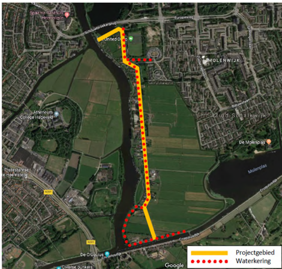
Afbeelding 1-2: Het deel van de Zuid-Schalkwijkerweg binnen de projectscope en het samenvallen met de waterkering.
