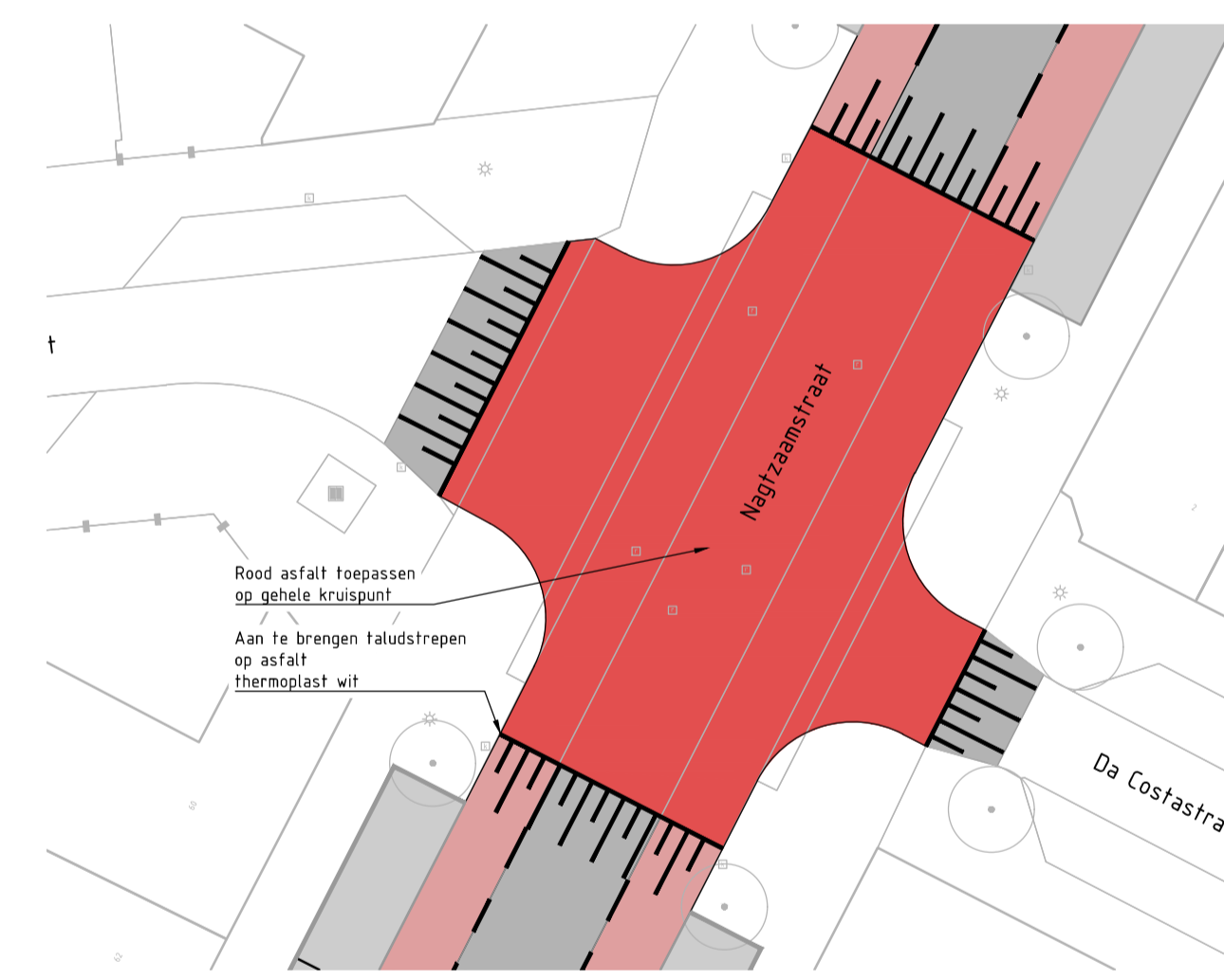
PRINCIPEDETAIL 5: Kruispunt Nagtzaamstraat SCHAAL 1 : 200 ZELFDE PRINCIPLE GELDT VOOR OVERIGE KRUISPUNTEN MET NR 5
