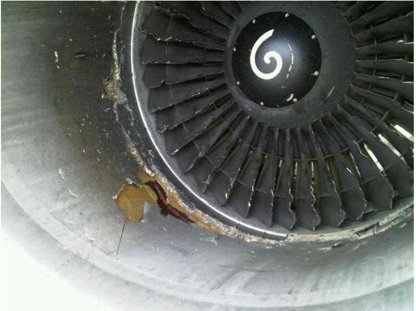
Afbeelding 5 en 6. Resten van een van de verongelukte ganzen in het linker landingsgestel en de ernstig beschadigde linker motor
