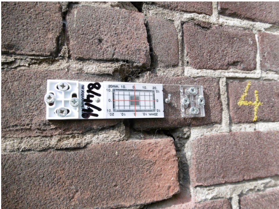
afb. boven: de doorgaande scheurvorming in de gevelaansluiting tussen het entreegebouw en het Oliehuis wordt middels een zgn. scheurmeter gemonitord
