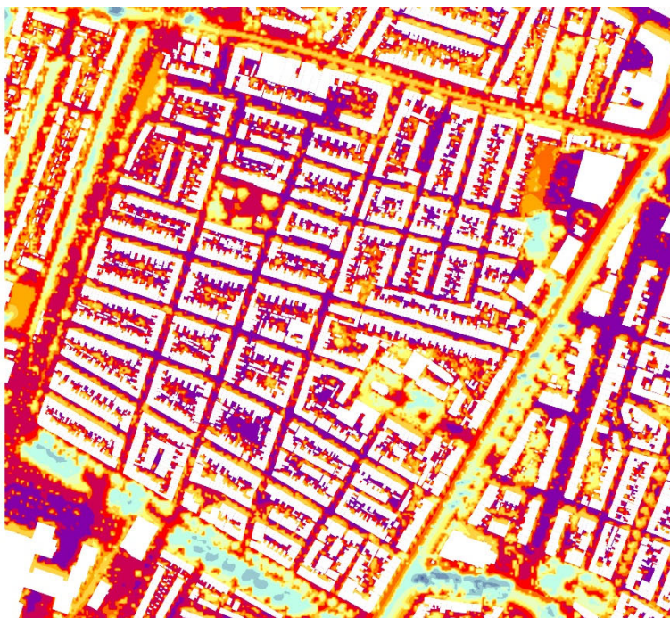
Figuur 18: Hittekaart Leidsebuurt bij huidige inrichting met de gevoelstemperatuur op een representatieve hete dag in 2050 om 15:00 uur op 1,5 m hoogte.
