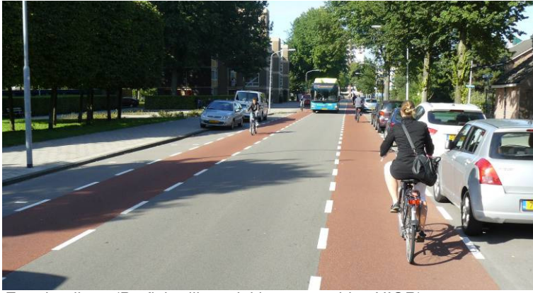
Engelandlaan (Profiel 'wijkontsluitingsweg' aldus HIOR): Enkele rijloper (en dus geen rijrichtingscheiding) en geen gescheiden voorzieningen voor auto- en fietsverkeer. Dit profiel voldoet niet aan de minimale eisen van het CROW voor een gebiedsontsluitingsweg.
