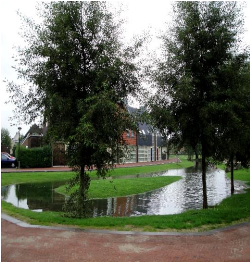
Figuur 3-1 Openbaar groen kan worden gebruikt om tijdelijk water op te vangen
