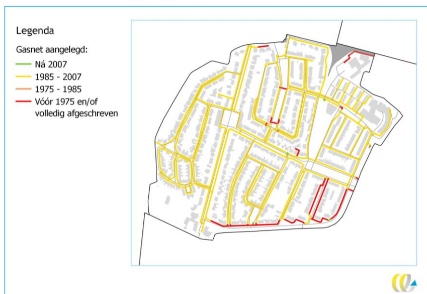
Figuur 33 - Leeftijd gasnet in het Ramplaankwartier
