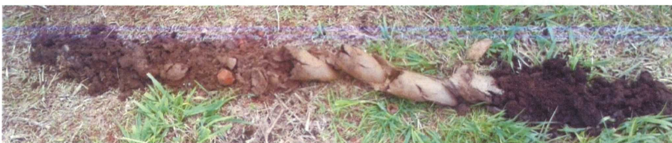
Bodemprofiel in Zwolle v.l.n.r.: Bovengrond, gemengde grond met zanderige materiaal, kleilaag en veen
