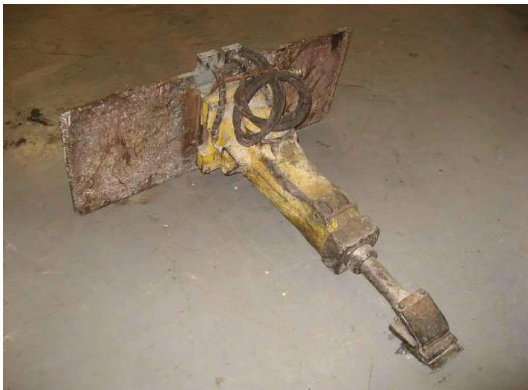
Figuur 31: Sloophamer aangebracht op bobcat
