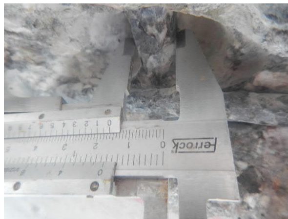
Figuur 3.12 : Vrijgemaakte langswapening \varnothing 16
