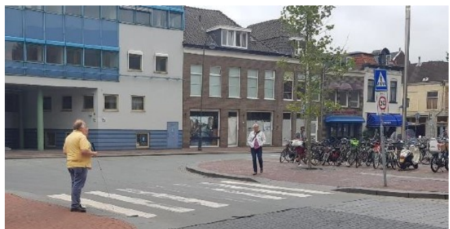
Smalle en onvoldoende contrasterende geleidelijnen op het stationsplein en geleidelijnen op de busbaan
