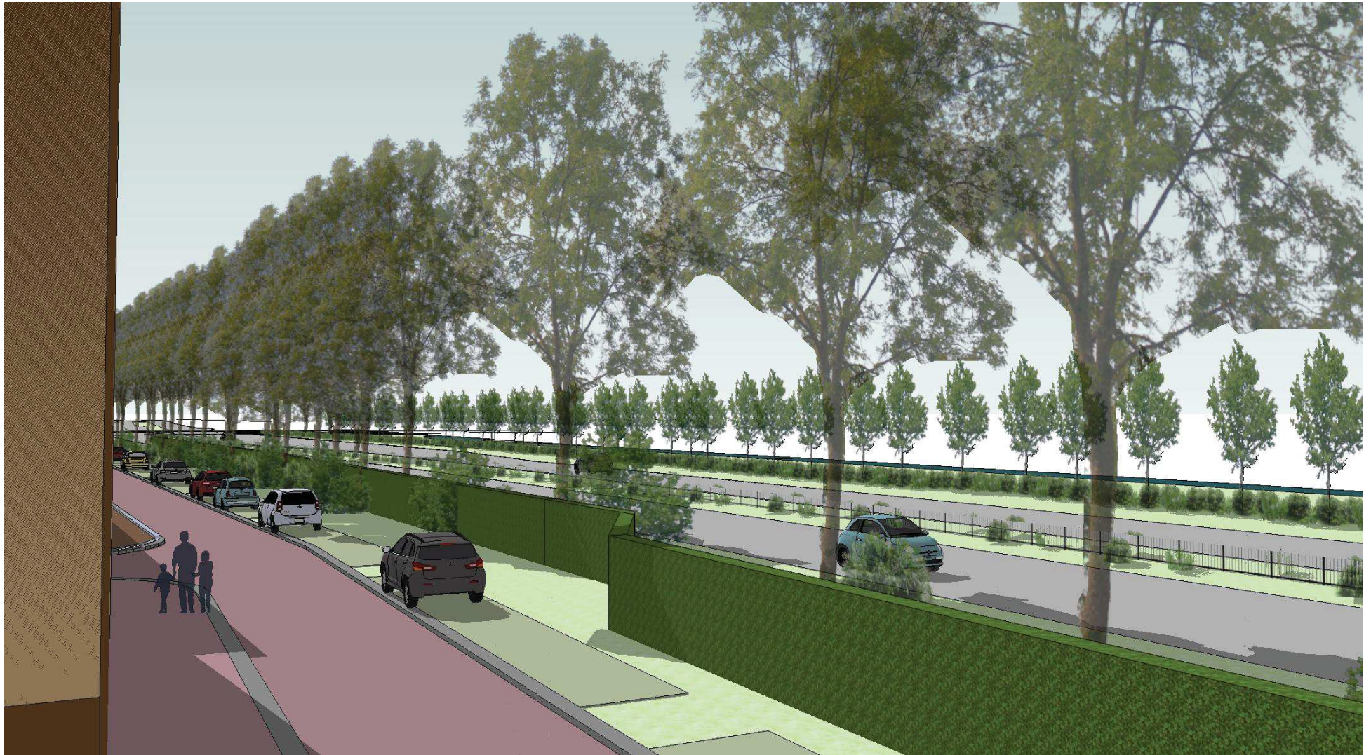
O5 1e verdieping geluidsscherm 2 meter hoog
