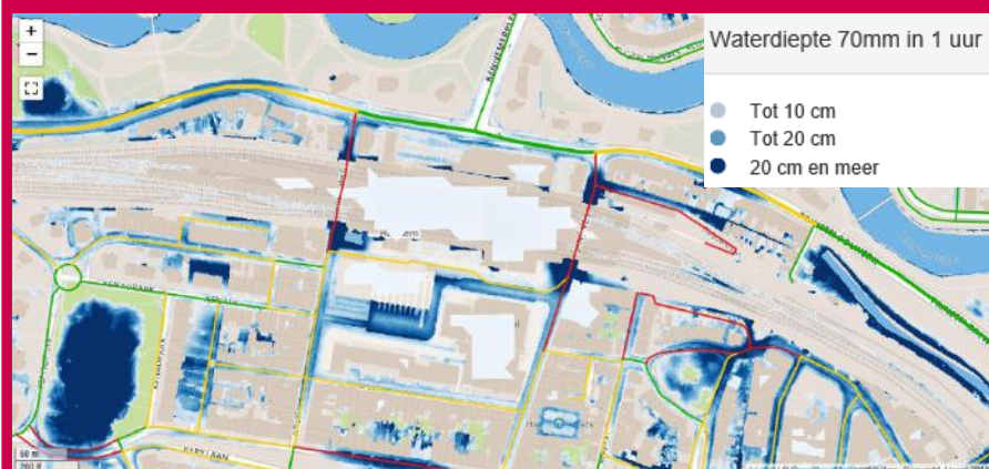
Figuur 5.5: De gevolgen van extreme neerslag in de stationsomgeving van Haarlem zijn met name te zien bij de onderdoorgangen onder het spoor en het busplein.
