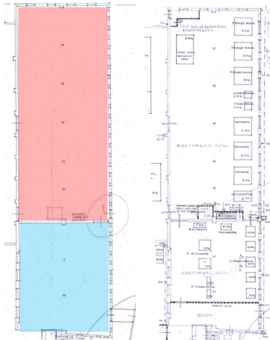
Plattegrond van de begane grond met rechts de nieuwe situatie en links de bestaande situatie op de tekening van 1954. In het rode vlak de nieuwbouw uit 1928 en in het blauwe vlak die van 1935. GABD.
