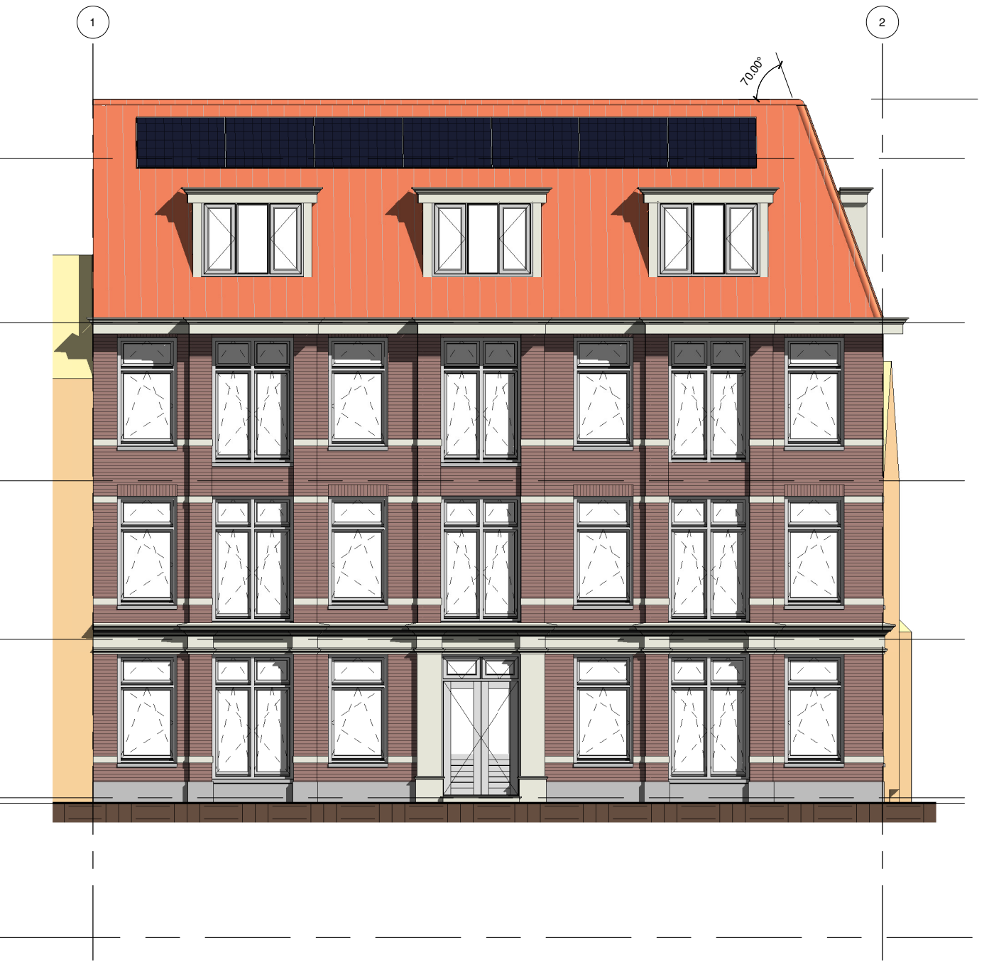
Vooraanzicht (Nieuw) Schaal 1 : 100
