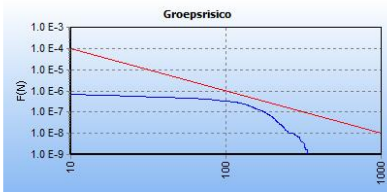
5.1 Figuur 5.1 FN curve voor 6805_leiding-W-532-01-deel-1 van N.V. Nederlandse Gasunie voor de kilometer tussen stationing 3100.00 en stationing 4100.00
