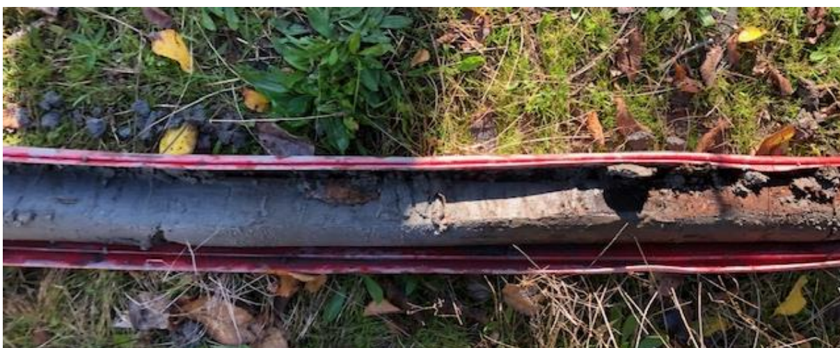
Foto van de top van de strandafzettingen met getijdeklei in boring 6 (400- circa 500 cm -Mv)
