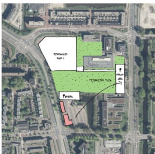
stap 5: personeelsgarage, sloop tijdelijke garage
