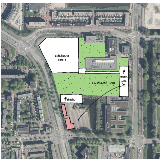
stap 5: personeelsgarage, sloop tijdelijke garage
