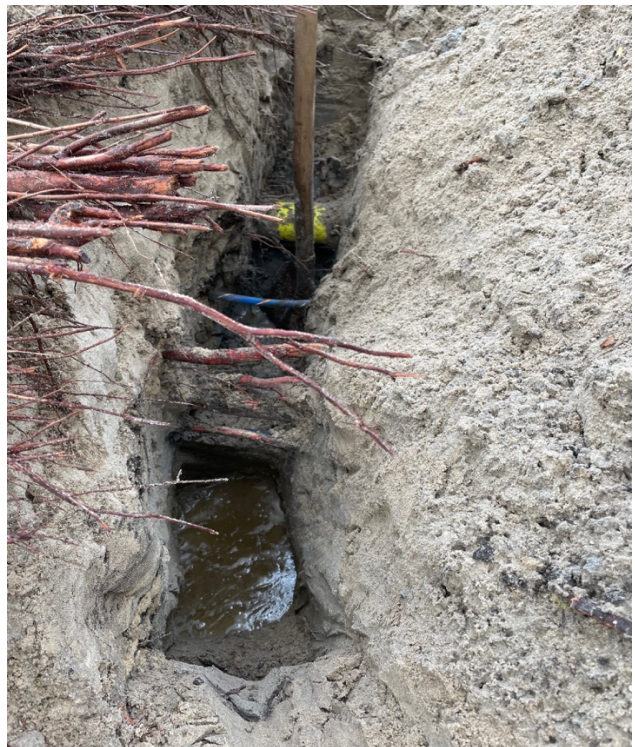
Foto 4 en 5: Links de blauwe bouwwateraansluiting aan boom 5. Op de voorgrond de proefsleuf met de wortelmat en enkele dikkere wortels. Rechts een detail van de proefsleuf met in het midden een spade en onderin de grondwaterspiegel. De bodem bestaat geheel uit grijs ophoogzand.
