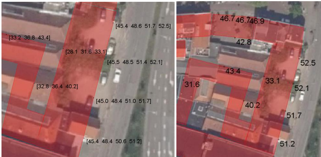
Afbeelding 4-8 Geluidbelasting in dB(A) etmaalwaarde per waarneemhoogte, 4 woonlagen.
