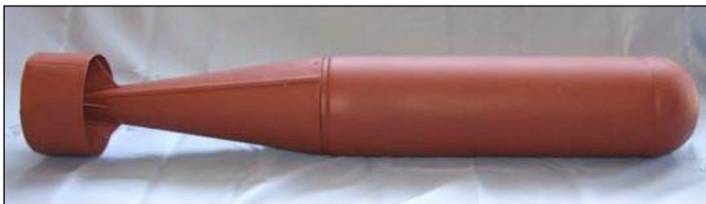
Figuur 42: Brandbom van 30 lb. Lengte ca. 830 mm, diameter 127 mm. Bron: IDDS.
