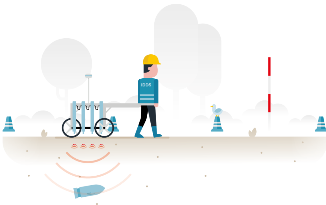
Figuur 48: Werkingsprincipe oppervlakedetectie middels een Multi sonde opstelling (handkar).
