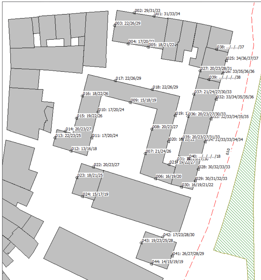
Afbeelding 4-4 Geluidsbelasting in dB, door verkeer op de Papentorenvest inclusief correctie (hoogte 1,5m/4,5m/7,5m/10,5m/13,5m)
