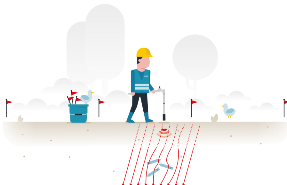
Figuur 47: Werkingsprincipe van detectie met een passieve detector.
