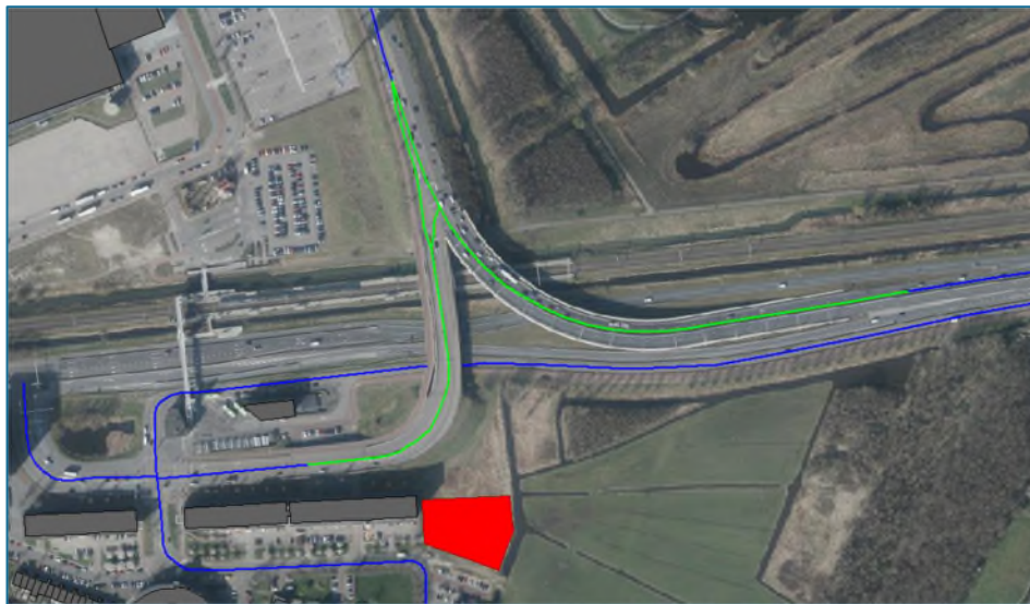
Figuur 5 Bronmaatregel Camera Obscuraweg (blauw = referentiewegdek, groen= SMA NL8 G+).
