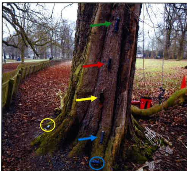
Foto 145 en 146: Rechts een beeld van de stam met bustafsterving, de oranje pijl geeft de locatie van korsthoutskoolzwam aan. Rechts een beeld van de sensor plaatsing. De inclinometers zijn met cirkels en de elastometers met pijlen aangeduid. De kleur correspondeert met de kleurcodering in tabel 101.
