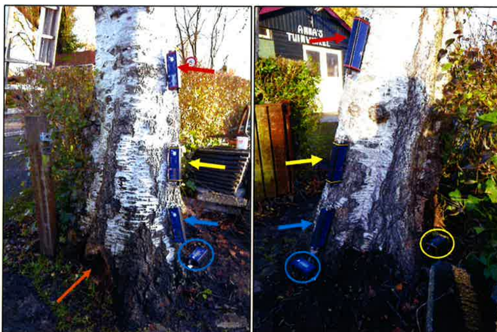
Foto 76 en 77: Een beeld van de sensorplaatsing. De inclinometers zijn met cirkels en de elastometers met pijlen aangeduid. De kleur correspondeert met de kleurcodering in tabel 54. De inrotting van de stamvoet is met een oranje pijl aangegeven.
