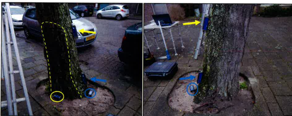
Foto 56 en 57: Links en rechts een beeld van de sensorplaatsing en de bloedingsplekken binnen de gele stippellijn. De inclinometers zijn met cirkels en de elastometers met pijlen aangeduid. De kleur correspondeert met de kleurcodering in tabel 40.
