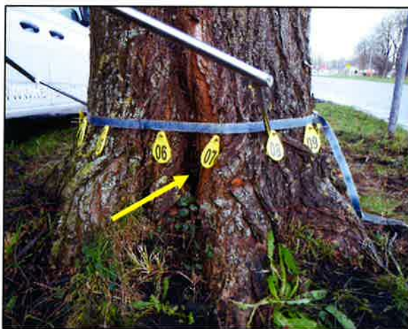
Foto 79 en 80: Links en rechts een beeld van de meetpunten op de stam en de inrotting (gele pijlen).
